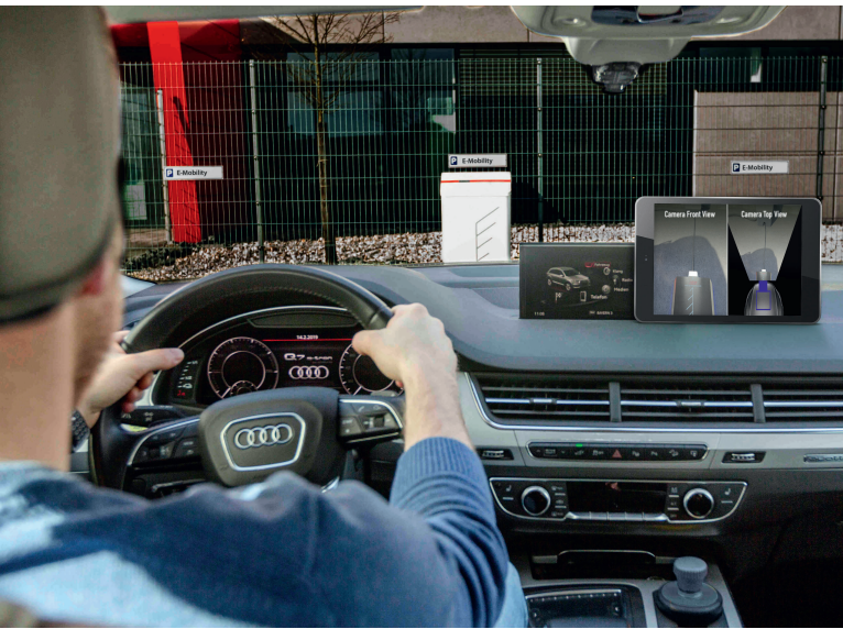
Bild 1: Ein weiteres Highlight in diesem Forschungsprojekt ist das integrierte Positionierungssystem, das dem Fahrer hilft, das Fahrzeug fehlerfrei über der Bodenspuhle auszurichten.
